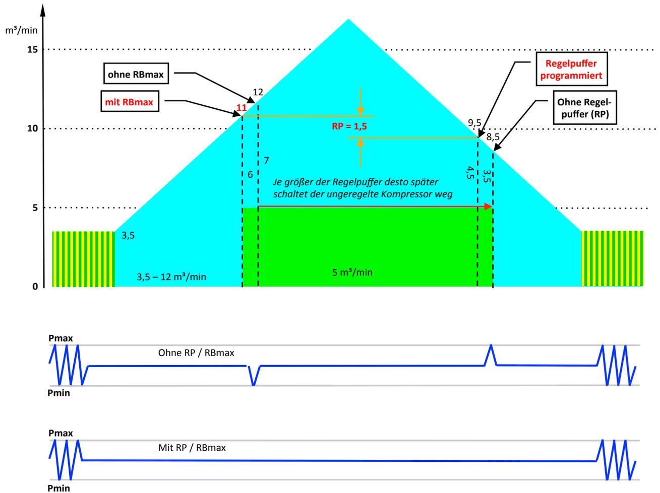
Bei der Verwendung der Regelparameter **RBmax** und **RP** werden die unregelten Kompressoren dynamisch geschaltet – also ohne Pmin und Pmax zu berühren!
