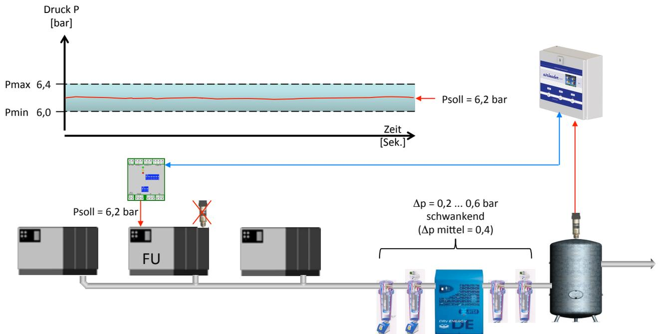
Der Airleader Steuerdruck steht in Form eines 4 – 20 mA Signals am **Analog-Ausgang AO** des RS 485 Anschlussmoduls im Kompressor zur Verfügung. Das Analogsignal kann entsprechend dem Druckbereich des Signal-Eingangs des Kompressors über das Menü skaliert werden. Standardmäßig ist 4 .. 20 mA = 0 .. 16 bar voreingestellt.
