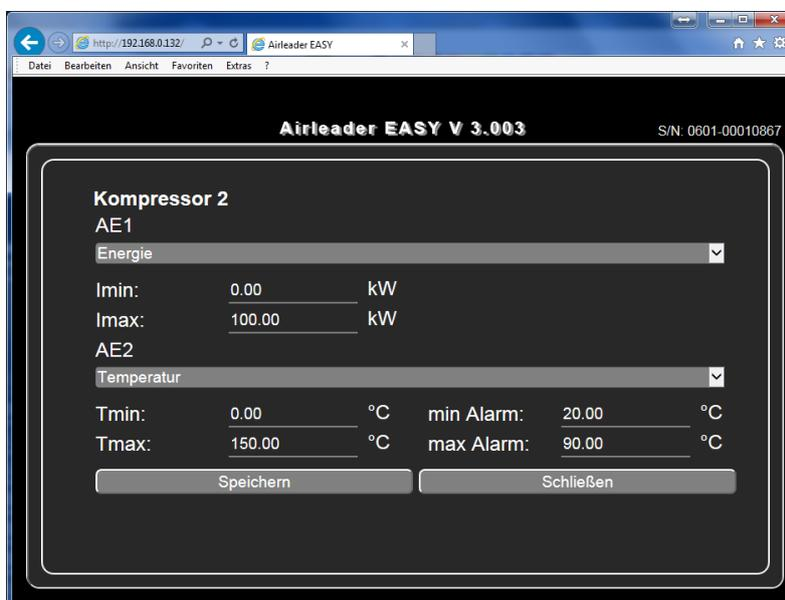
Je nach ausgewähltem Kompressortyp, stehen 1 oder 2 Analogeingänge für zusätzliche Sensoren zur Verfügung.
