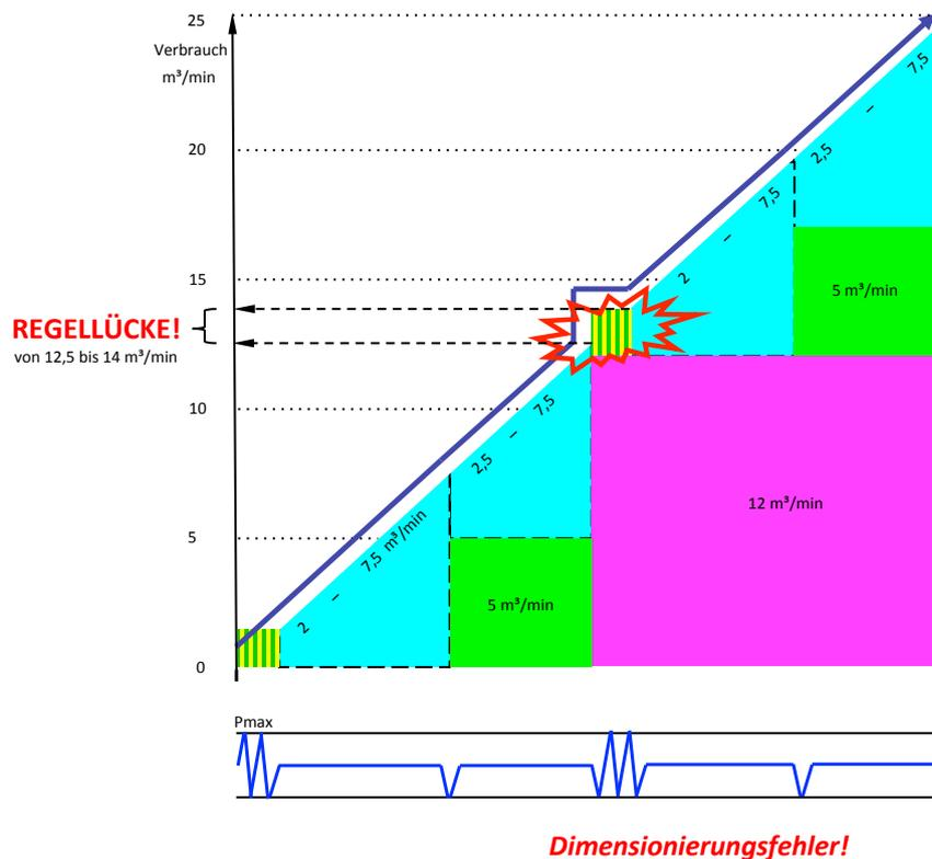
Kompressor unter seine minimal Liefermenge und der Druck steigt bis  $P_{\text{max}}$ , wo der soeben zugeschaltete Kompressor wieder abgeschaltet wird. Die Folge ist, dass nun der geregelte Kompressor vom Stillstand oder Leerlauf wieder auf volle Leistung geht, trotzdem nicht ausreicht und der soeben abgeschaltete Kompressor wieder zuschaltet.
