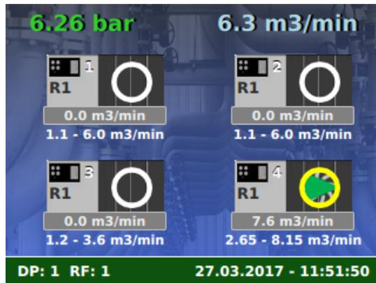
Auf dem Display der EASY Steuerung sehen Sie die aktuellen Zustände der Kompressoren, bei FU-Kompressoren zusätzlich die variable Liefermenge, sowie den Netzdruck und den aktuellen Gesamtverbrauch.
