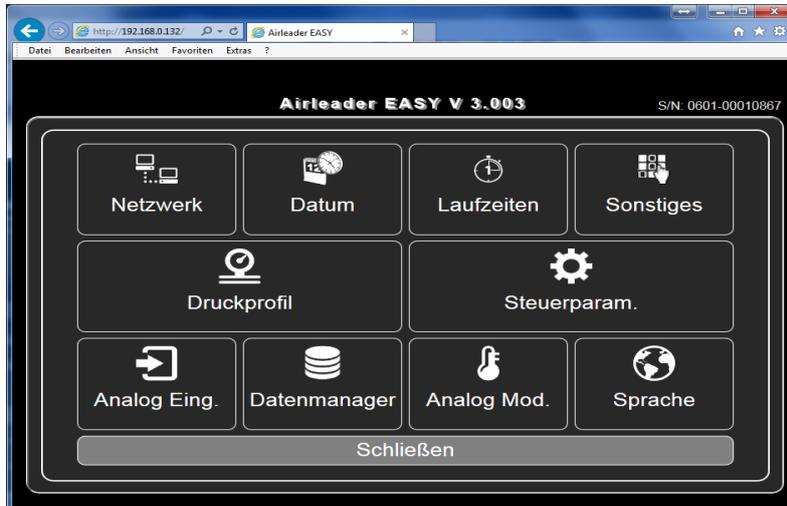
Ein Klick auf das Zahnradgetriebe in der Fußzeile des Hauptscreens, öffnet in das Einstellungs Menü.
